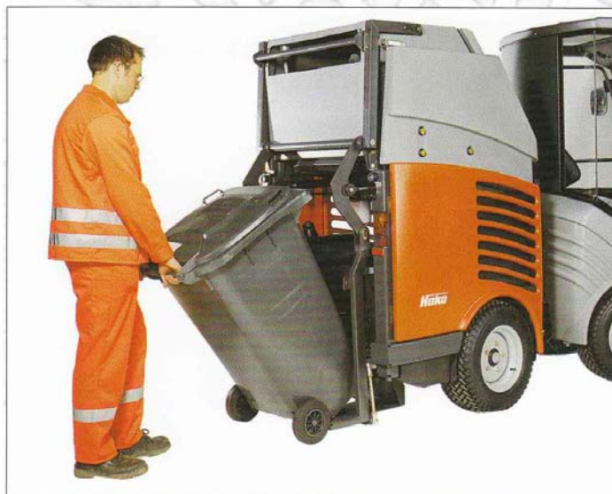
Obr. č. 3 HAKO Citymaster 300 – výměna odpadní nádoby
