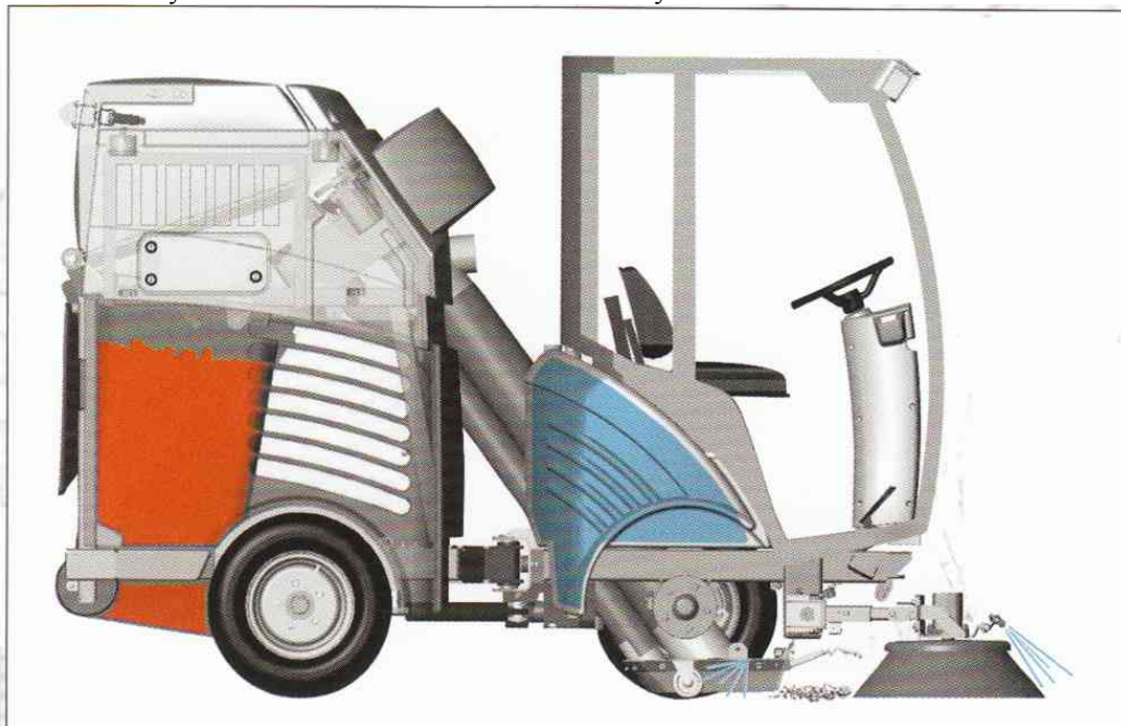
Obr. č. 2 HAKO Citymaster 300 – schéma zametání + vodní systém
